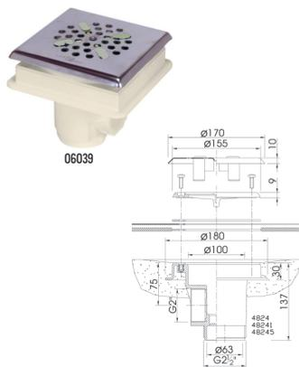
06039 **Bodenablauf mit Blende V4A gelocht Typ MTS** (4824) 196,40
