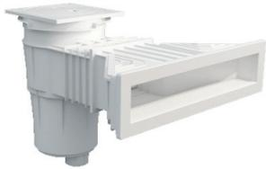
456176 **Oberflächenabsauger SLIM 500 KS, Farbe weiß mit Saugplatte u. Blende** für Beton-Folienbecken. Material ABS, mit Deckel und Überlauf, 17,5 Liter, Anschluss: 1 1/2" I.G. zum Filter, 2" I.G. vom Ablauf
