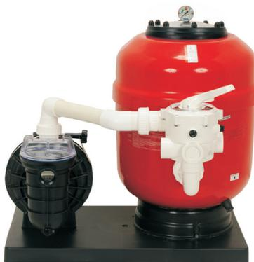
15853 **EUROPA-Kompaktfilter D 450 mm Farbe rot mit 6-Wege-Ventil verrohrt und Starite-Filterpumpe Duraglas C 1 salzwasserbeständig 0,4%, 0,37 KW, Wechselstrom 230 V (steckerfertig), montiert auf Bodenplatte (ohne Filtermaterial) Abmessungen: L x B x H; 82 x 69 x 89 cm** 1.699,00
